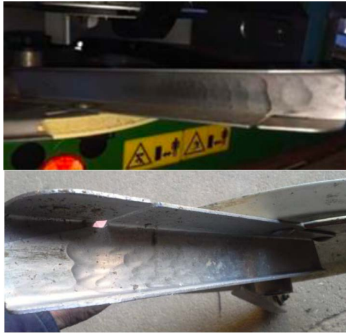
Exemple d'aubes usées à remplacer
